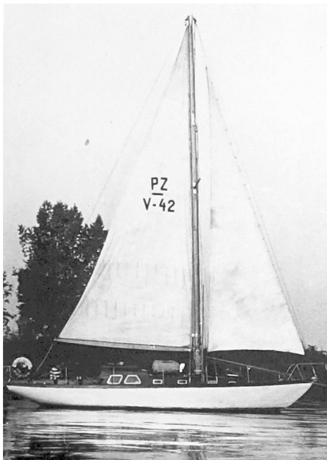
Fot.10. s/y Wagabunda pod żaglami zacumowana na przystani POGOŃ w Szczecin Dąbiu. Zwraca uwagę bom foka, którego zastosowanie umożliwiło halsowanie przez sternika bez udziału załogi. Bom ten był wykorzystywane krótko, w pierwszych latach pływania.
